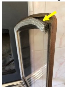
Deficient door gasket
