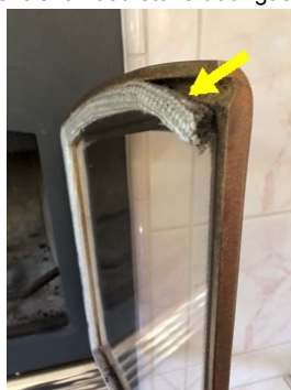
Deficient door gasket
